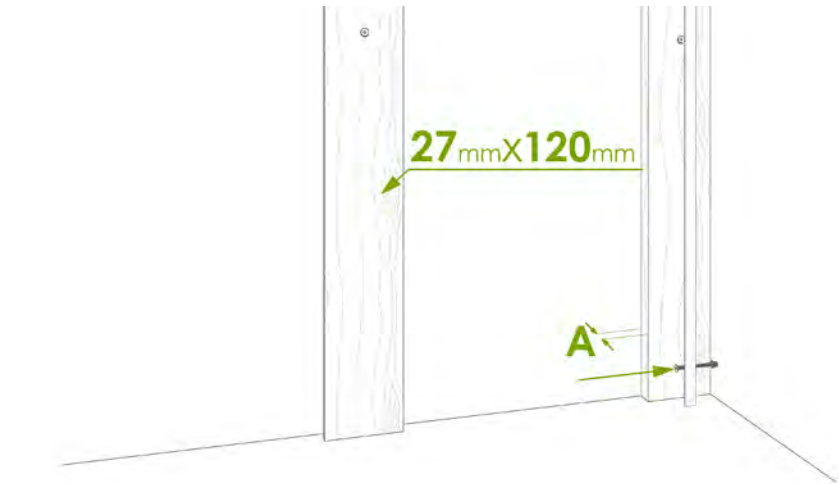
Abb. 4c: Montage Wandanschlussprofil A = Abstand von Wand zu Außenkante Unterkonstruktion
