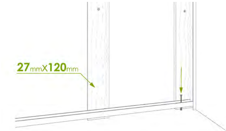
Abb. 4d Detail: Vorschlag Abschlussvariante zum Boden – Bodenprofil
